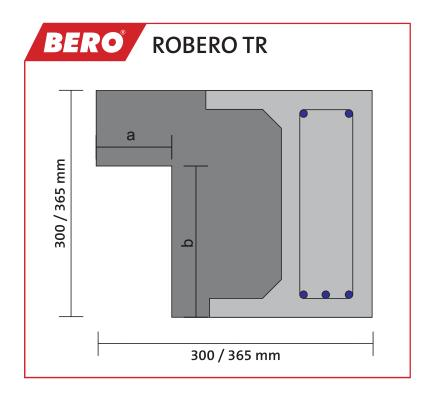
Statisch tragendes Schalungselement zur Aufnahme eines Vorbau Rollladen- oder Jalousiekastens aus Aluminium. Lastwerte nach Tragfähigkeitstabelle. Dämmung und isoliertes Auflagerteil aus BERO® Porozell (WLSO31).
